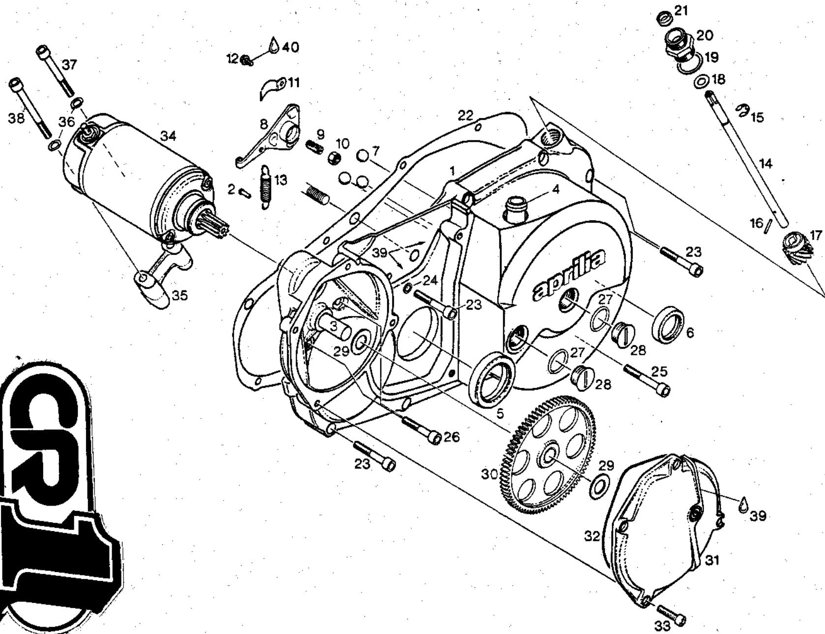
KUPPLUNGSDECKEL, DREHZAehlerANTRIEB, ELEKTRO-
