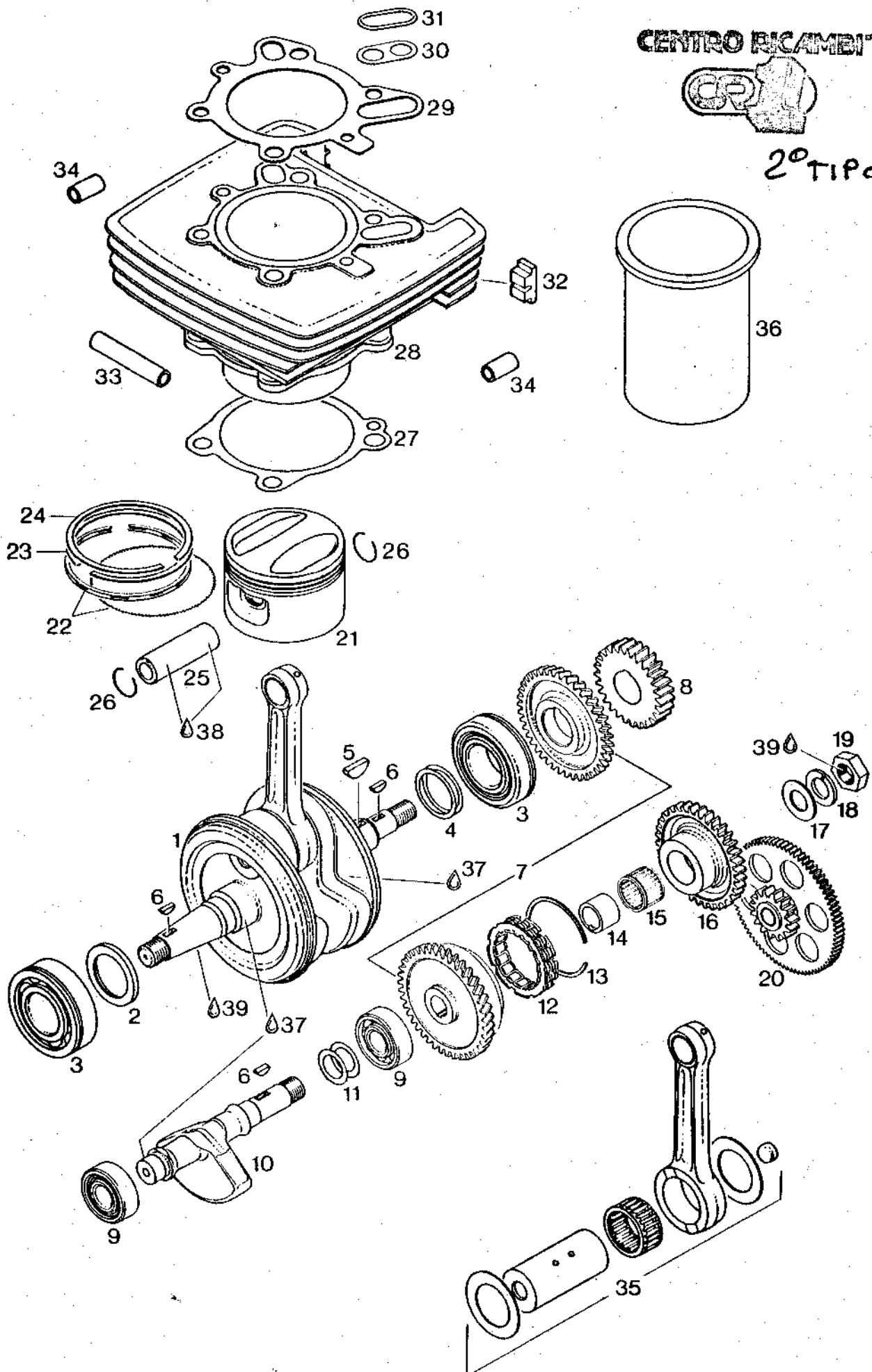
KURBELWELLE, AUSGLEICH-S-U. STARTERTRIEB, ZYLINDER
