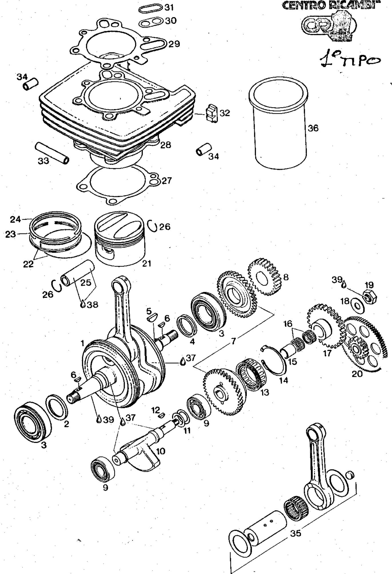
KURBELWELLE, AUSGLEICHS- U. STARTERTRIEB, ZYLINDER
